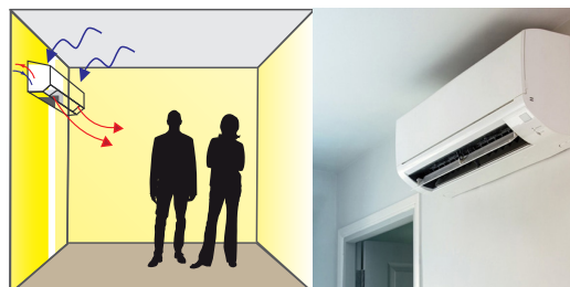
Figura 21. Esquema de funcionamiento de fan coil y fan coil instalado
