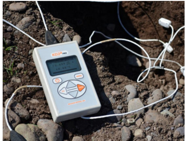
Foto 7. Exploración propiedades térmicas del suelo. Sonda KD2Pro de Decacon Device. CEGA.
