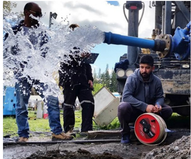
Foto 8. Prueba de bombeo en Liceo Altos del Mackay, Coyhaique. CEGA.
