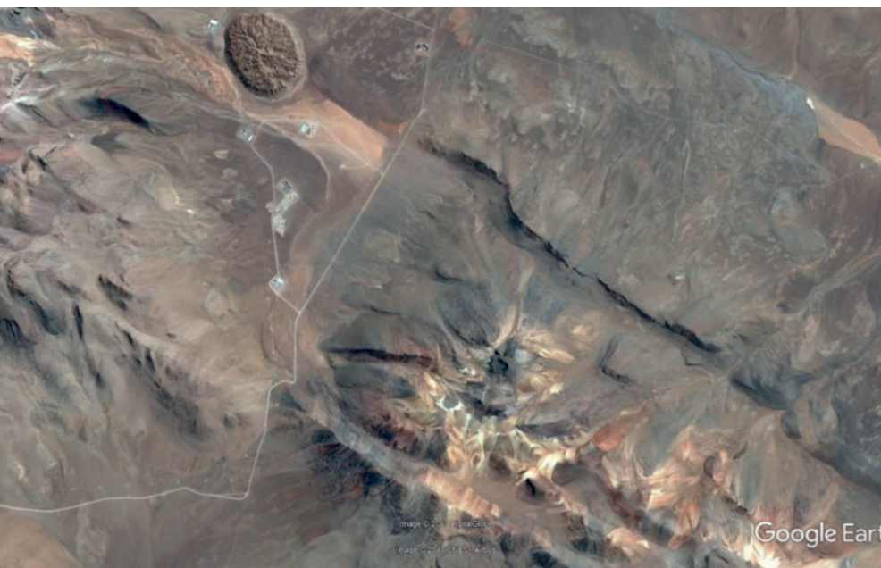
Figura 3. Imagen de la Pampa Apacheta con la ubicación de la planta geotérmica Cerro Pabellón y los pozos de reinyección. Los rasgos topográficos que destacan son los del Domo Cerro Pabellón y los escarpes de los sistemas de fallas NW-SE que controlan la permeabilidad secundaria en el reservorio del sistema geotermal Cerro Pabellón. Fuente: adaptado de (Imagen: Google Earth ©).
